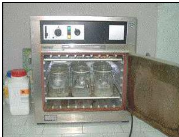
Figure-III-7:Appareillage pour la détermination des isothermes de sorption
