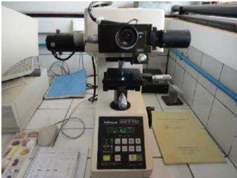
Figure II.7: Microduromètre Matsuzawa MXT 70.
