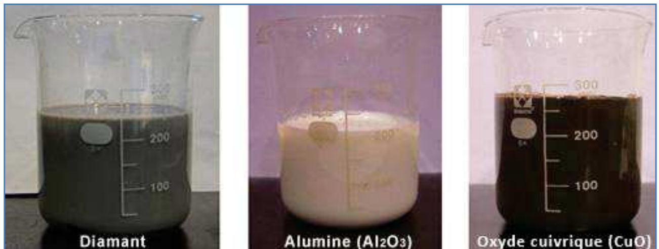
Figure 1.3: Exemples de nanofluides aqueux et opaques avec seulement 1 % de nanoparticules de diverses natures [6]
