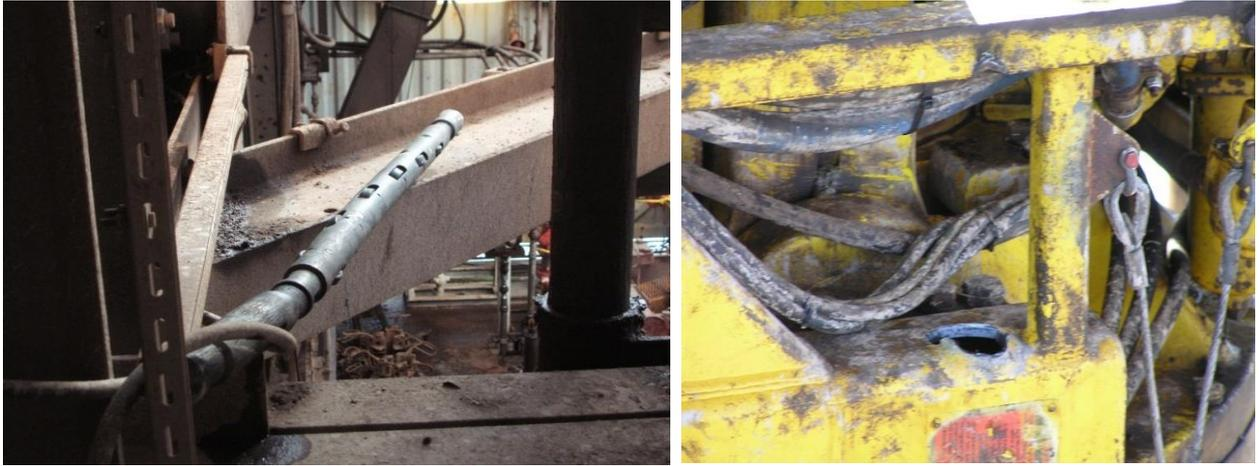
**Figure II-11** : Photos de top drive après la coupure de slickligne [12].
