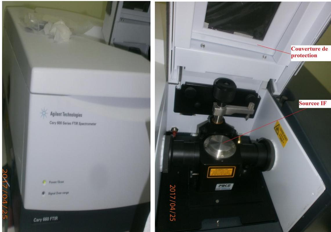
**Figure III-11** : Spectromètre IF.
