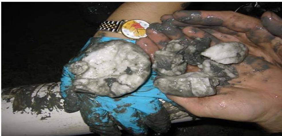
Figure II-02 : Photos réelle des hydrates récupérés durant le transport [12].
