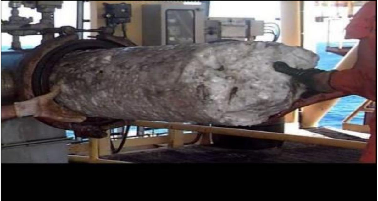
**Figure II-12** : Photos de bouchage causé par les hydrates dans une conduite de transport [12].
