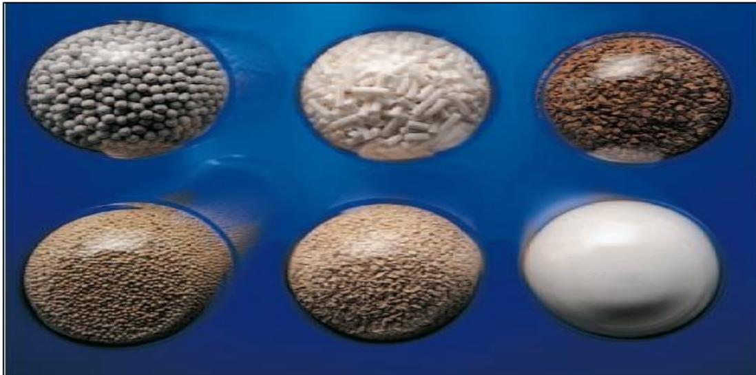
**Figure III-19** : Photo réelle des différents types des tamis moléculaires [11].
