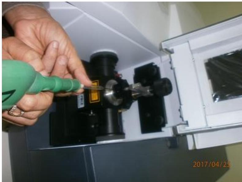
**Figure III-13** : Pose d'échantillon.
