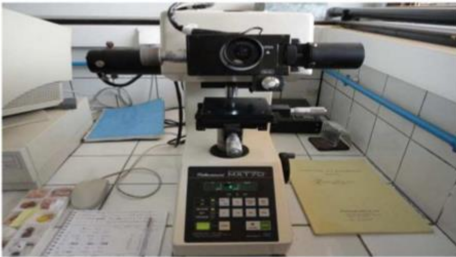
Figure II.9 : Microduromètre Matsuzawa MXT
