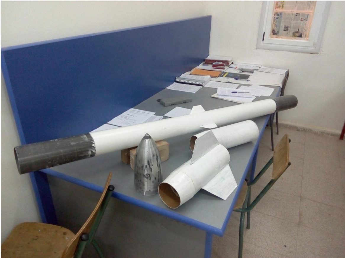
الشكل 6: صورة للصاروخ AMSEC-R v.01 وهو مجزئ.
