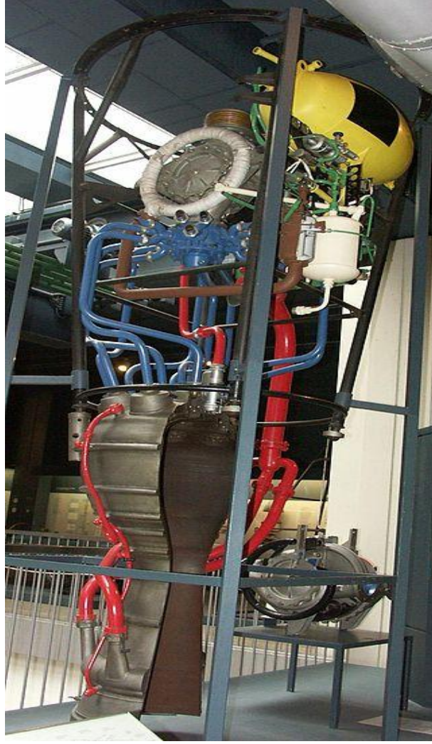
الشكل 6.2: صورة لمحرك الفاو-2 "متحف التاريخ الألماني ميونخ Deutsches schiffahrts Museum-Munich".
