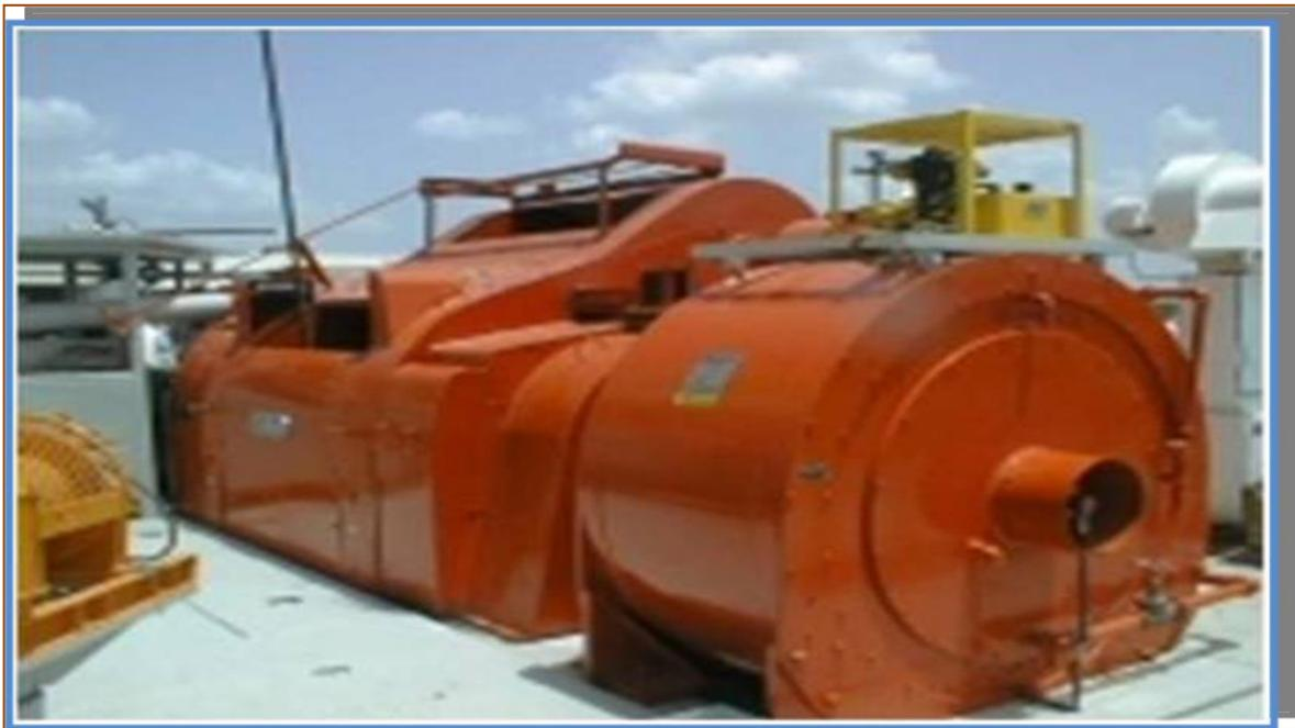
Fig. I.2 : Treuil de forage.
