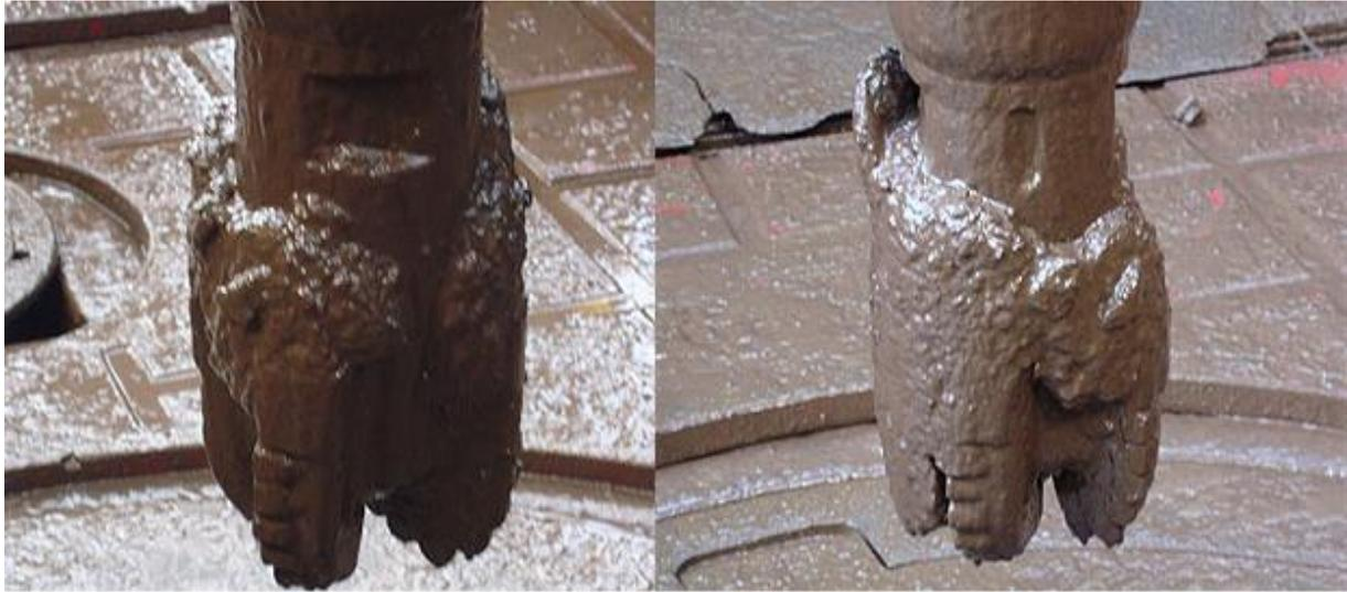
**Fig. I.22 :** bourrage de l'outil à cause de mauvaise nettoyage.
