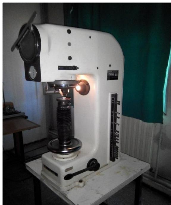
Figure 19 : Duromètre 'Wolpert'
