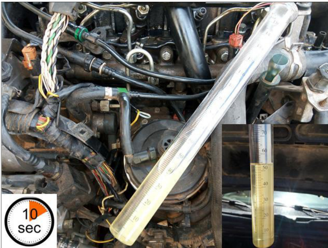
Figure 2.13 Mise en place de l'éprouvette
