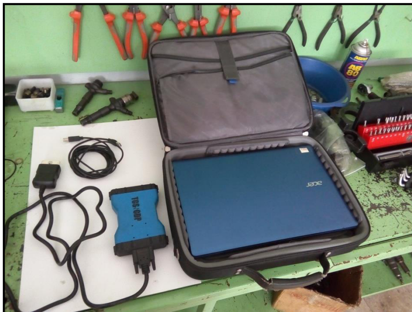
Figure 3.8 Scanner de diagnostic véhicules DELPHI
