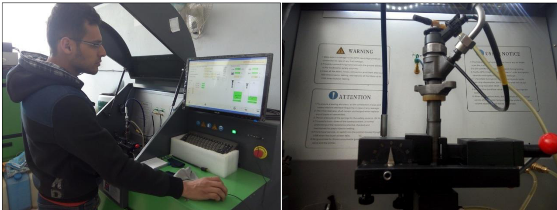
Figure 3.11 montage d'injecteur et mise en marche du banc d'essai
