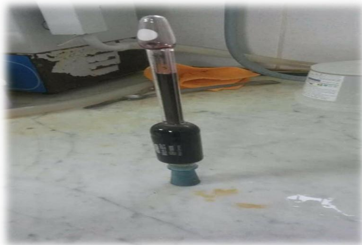
Figure 05: Mesure de la matière grasse lait de brebis.
