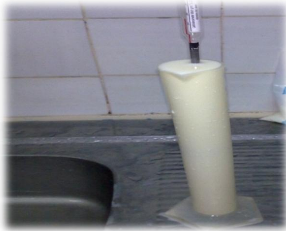
Figure 04 : Mesure de la densité lait de brebis par le lactodensimètre.
