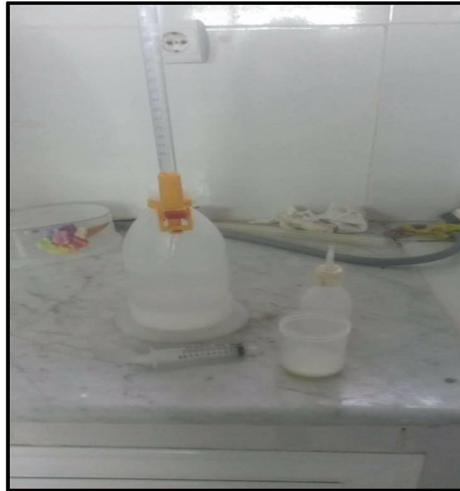
Figure 03 : Mesure de l'acidité titrable du lait de brebis.
