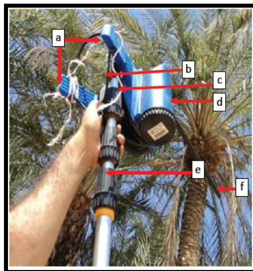
Figure 44: Pollinisateur : a) bras de la poudreuses; b) baguettes de rappel; c) fil de tirage ; d) poudreuse ; e) perche télescopique; f) jeteur de la poudre. (Nourani et al. 2017)
