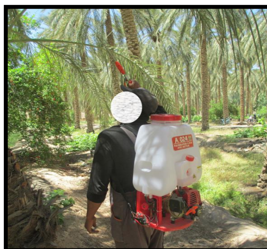
Figure 65 : Pulvérisateurs à moteur pour traitement phytosanitaires au sommet .
