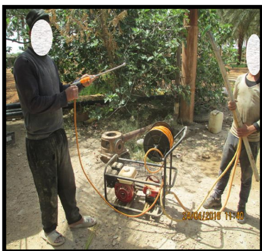
Figure 65 : Pulvérisateurs à moteur pour traitement phytosanitaires au sommet .
