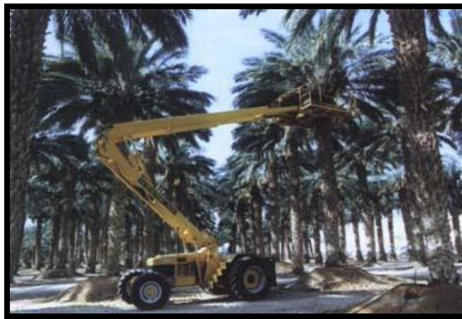
Figure 38 : Récolte à laide d'un élévateur à nacelle aux Etats Unis
