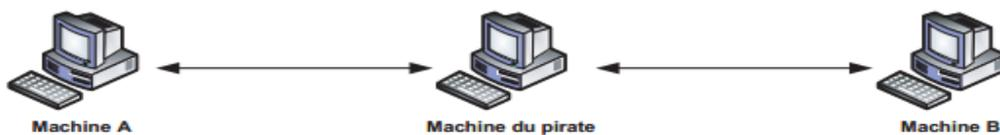
Figure 2.9 : Machine du pirate en tant que relais applicatif.
