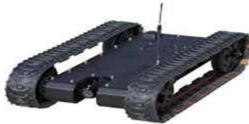
**Figure I.11** Robot mobile à chenille [7].
