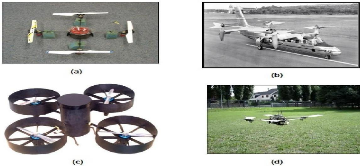
*Figure 1-6 : Hélicoptères à quatre hélices: quadrotor de pennsylvanie (a), X19 quadtilt-rotor aircraft (b), le drone du laboratoire IBISC (c) et le drone de la NASA (d)[6].*
