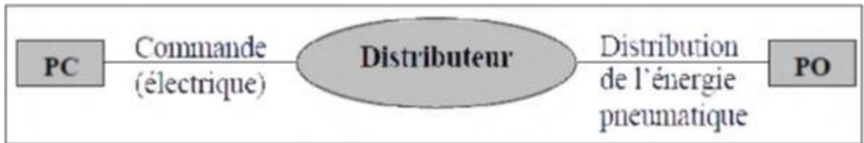
Figure I-17 : Principe de fonctionnement de distributeur [3]
