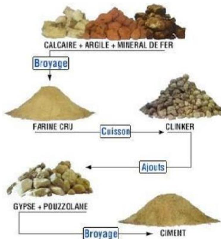
Figure 1.3 : schéma d'obtention du ciment [2]
