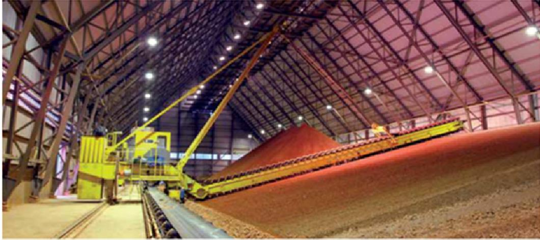
**Figure III .2 : Machine Gratteur.**
