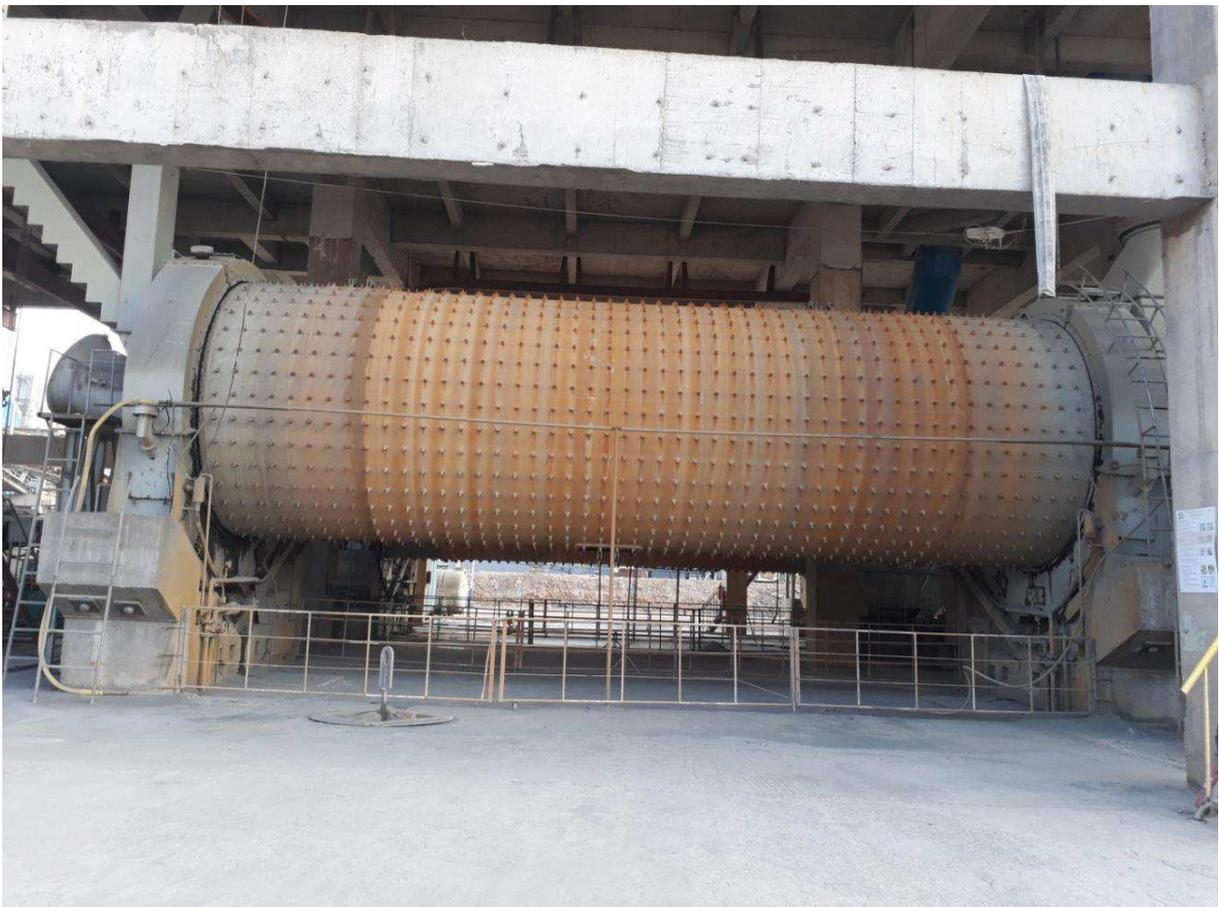
**Figure I.12 : Le Broyeur ciment [1].**
