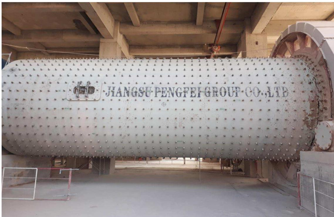
**Figure I.7 : Le Broyeur cru. [1]**
