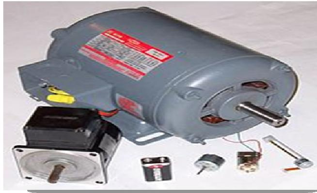
**Figure III.13 : Moteur électrique.**
