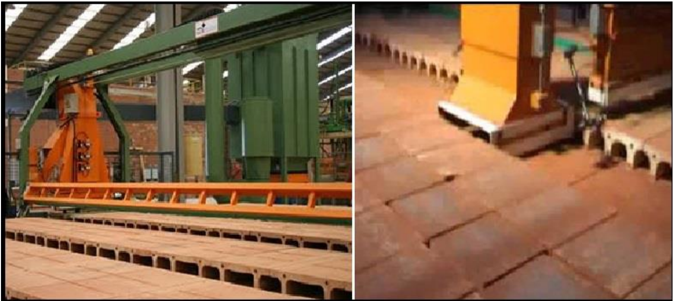
Figure I.19 : Nettoyage des wagons
