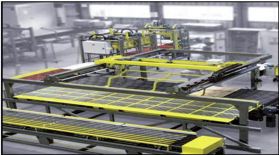
Figure I.13 : la table à rouleaux et pousseur
