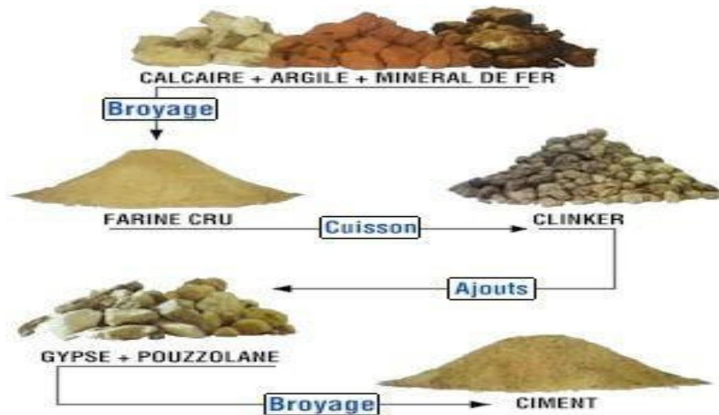
Figure 1.2 : Les étapes de fabrication du ciment.
