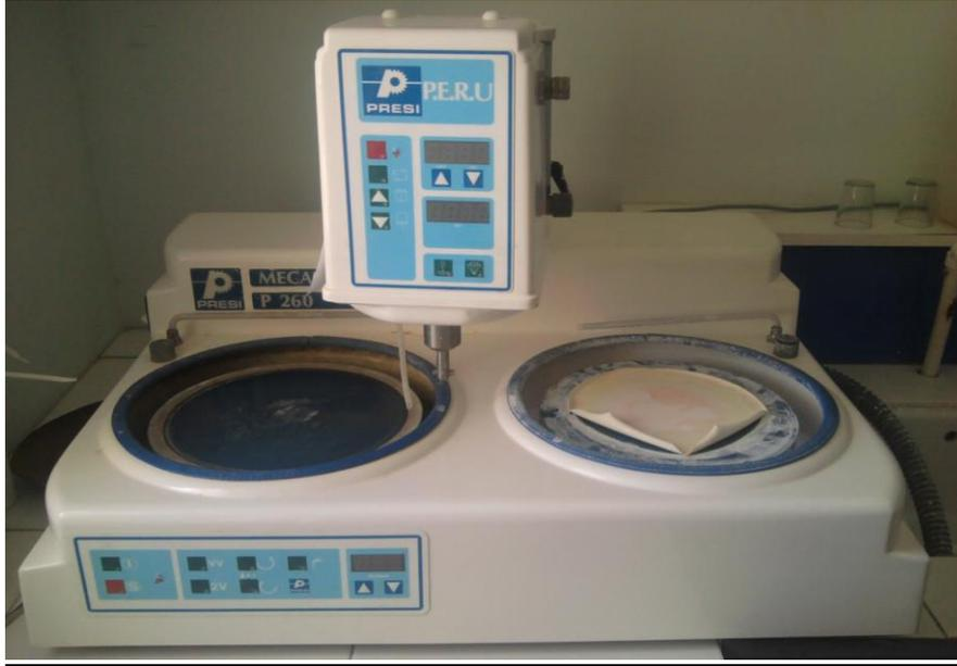
**Fig 3 : Polisseuse MECAPOL PRECI**
