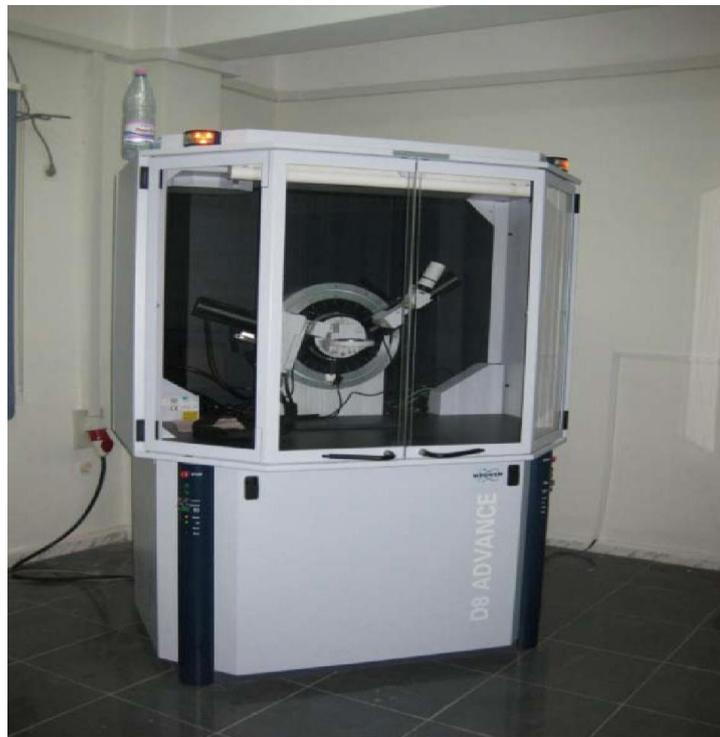
**Fig 4: Diffractomètre à rayons x de type Bruker D8 ADVANCE**
