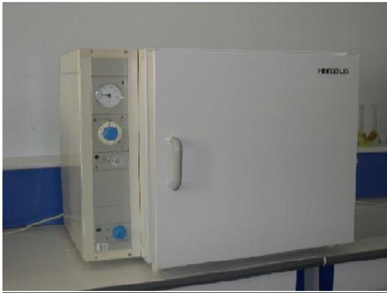
**Fig 2 : étuve de recuit  $T_{\max}$  300°**
