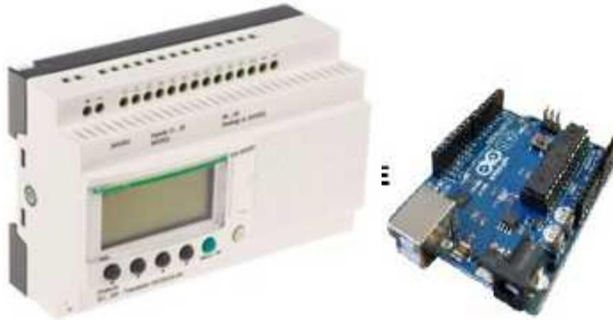
**Figure I.18** Automate programmable et microcontrôleur
