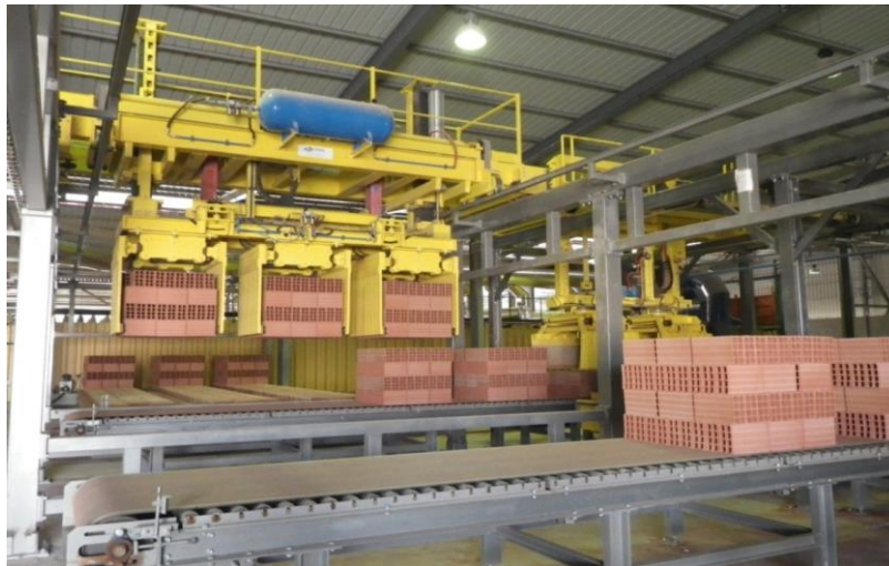
Figure.I.2. Image de portique de dépilage.
