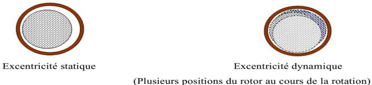
**Fig III.1** : L'excentricité statique et dynamique d'un moteur asynchrones [ACH 14].
