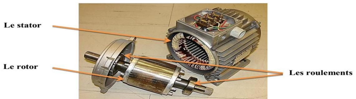
**Figure I.4:** Stator et Rotor à cage d'écureuil d'une machine asynchrone.[MEN 17]
