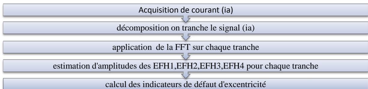
**Fig. III.2** représente les différentes étapes constituant l'algorithme proposé pour la détection de défauts d'excentricité.
