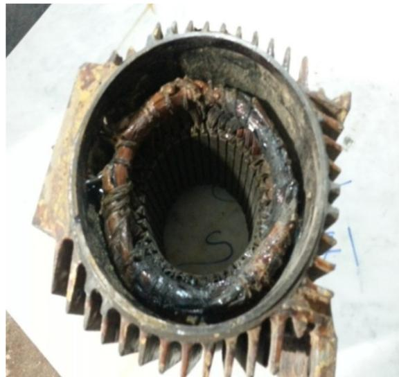
Figure I.6 : Stator d'un moteur asynchrone complètement grillé.
