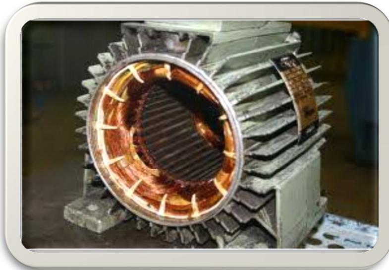
Figure I.3 : Le stator.
