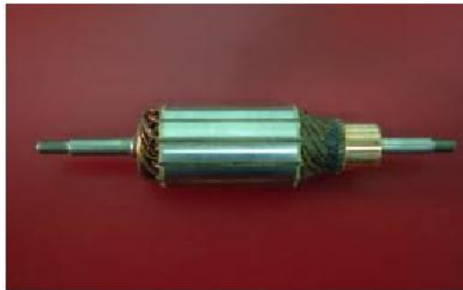
Figure I.3 : L'induit d'une machine à courant continu. [4]
