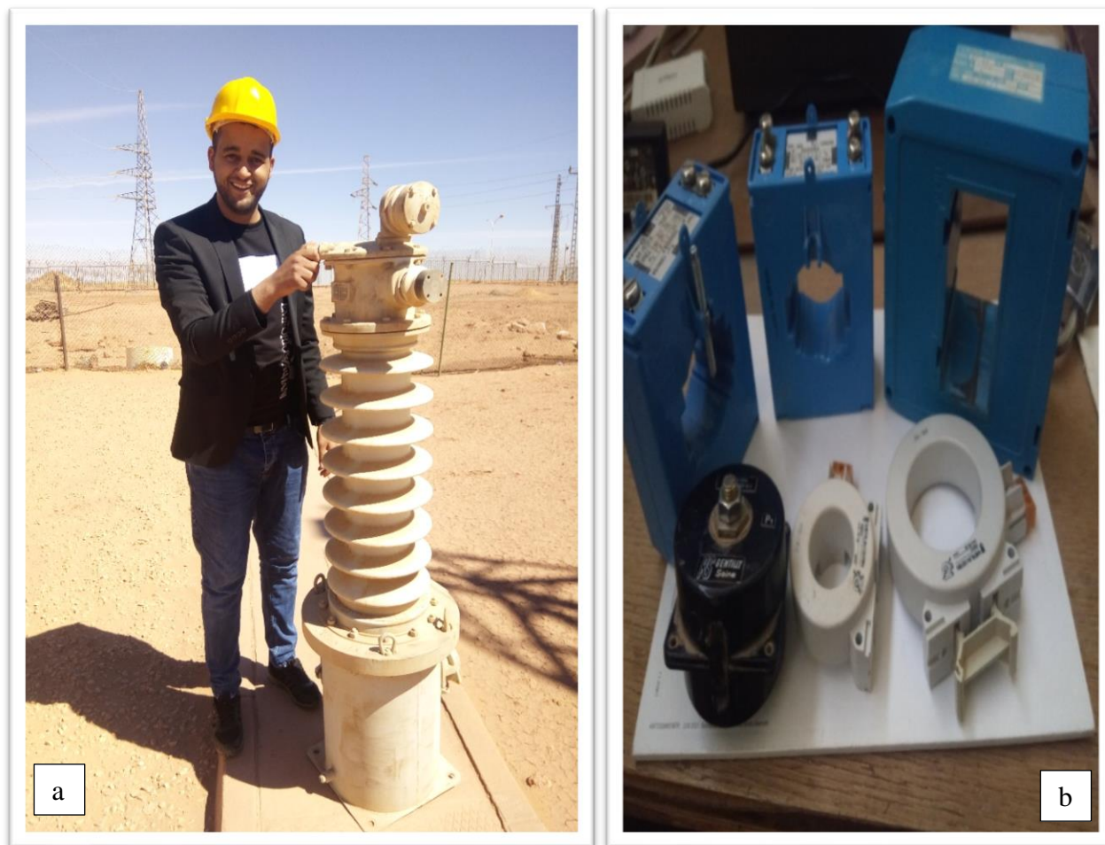
Figure I.13 : Transformateur de courant :
