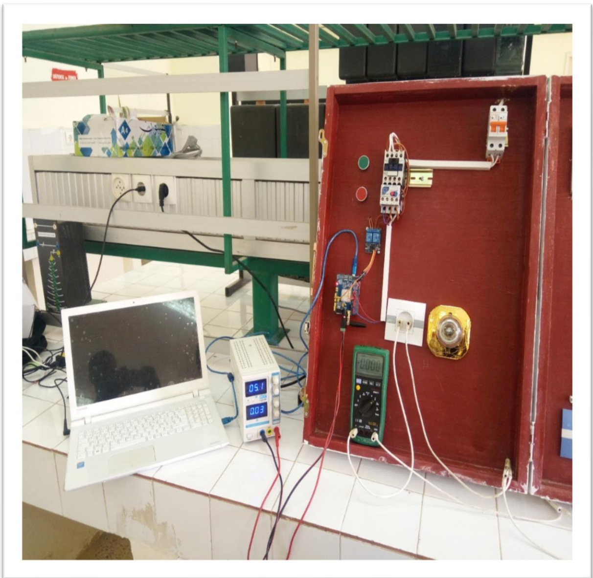
Figure III.27 : Photo du circuit de commande des relais à distance par carte GSM.
