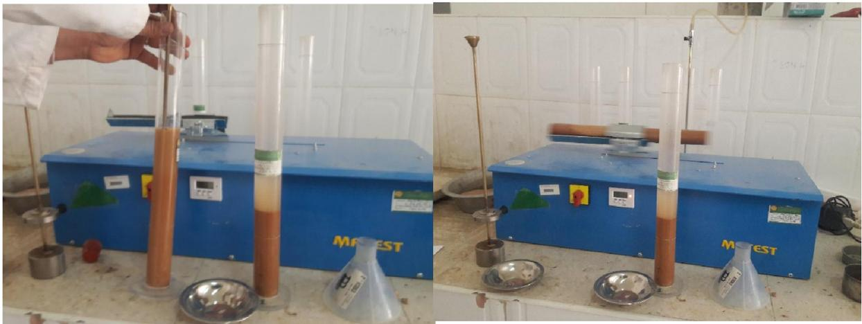
Figure IX-5- essai d'équivalent de sable
