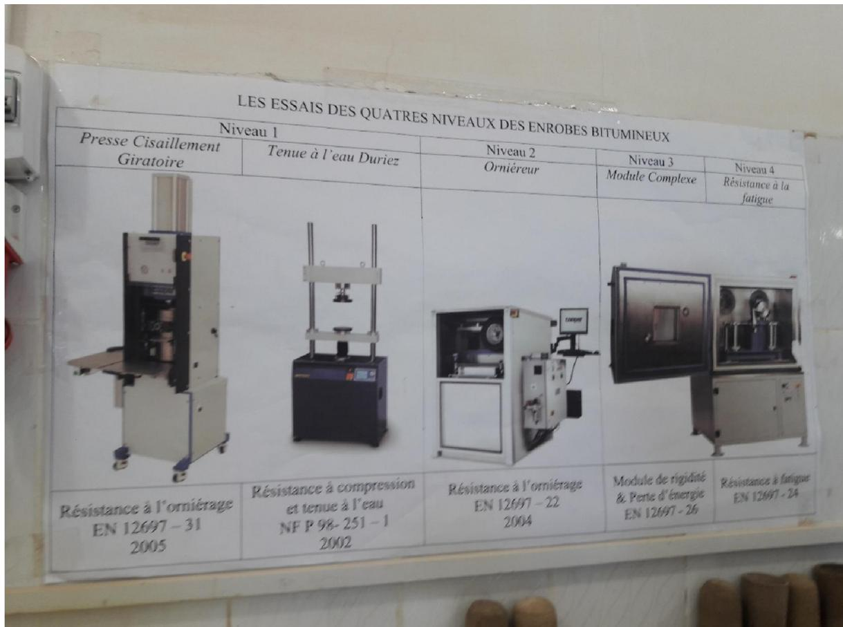
Figure IX -14- les essai des quatre niveaux des enrobes bitumineux
