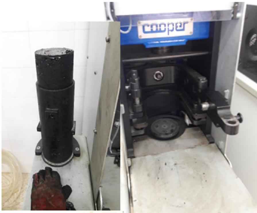
**Figure IX-13- Presse à Cisaillement Giratoire**
