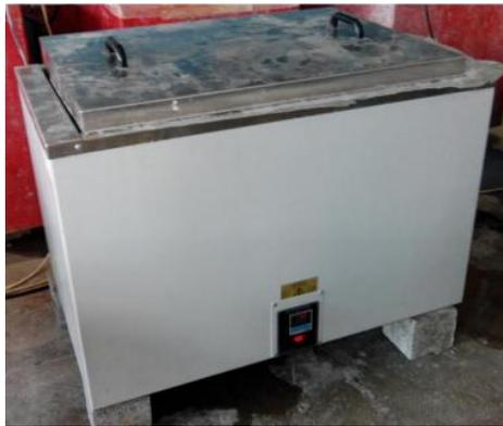
Figure 3.4: réservoir à bain d'eau chaud à 80°C.
