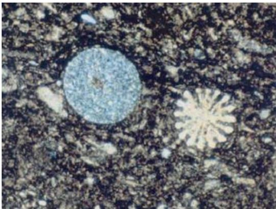
Figure 2.5 : calcaire siliceux réactif  $\text{SiO}_2$  15 à 20 % (qualification PR) [8]
