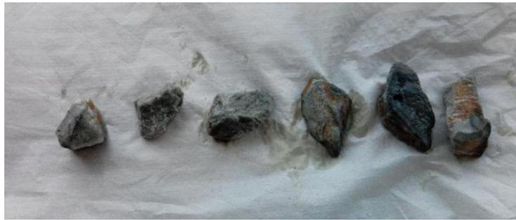
Figure 3.7 : Texture du granulat de Quartzite
