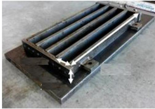
Figure 3.1 : Moules d'une barre de mortier.
