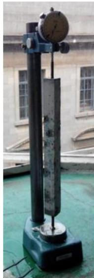
Figure 3.2 : Support de mesure d'élongation
