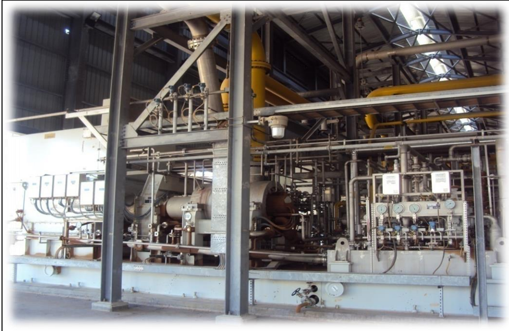
Figure IV.17. Compresseur de gaz miscible MF
