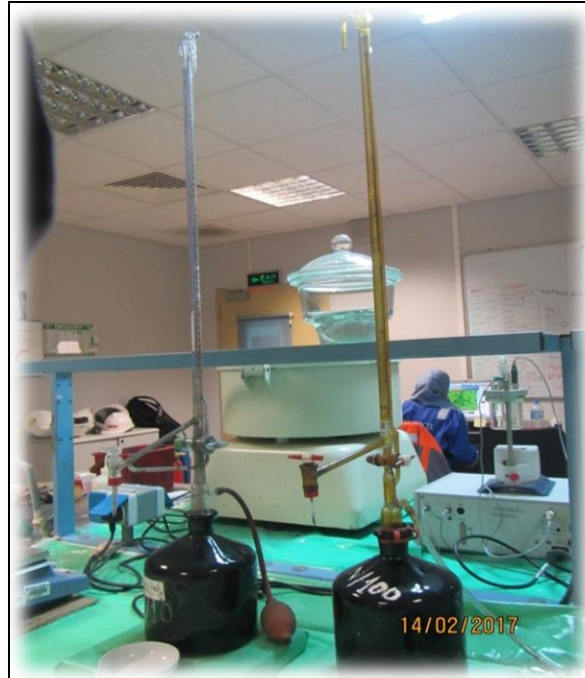
FigureIII.10. Mesure de la salinité du brute
