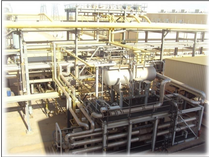
Figure IV.8. le ballon collecteur et accumulateur de condensat ( Condensate Drum ) a New Zotti.
