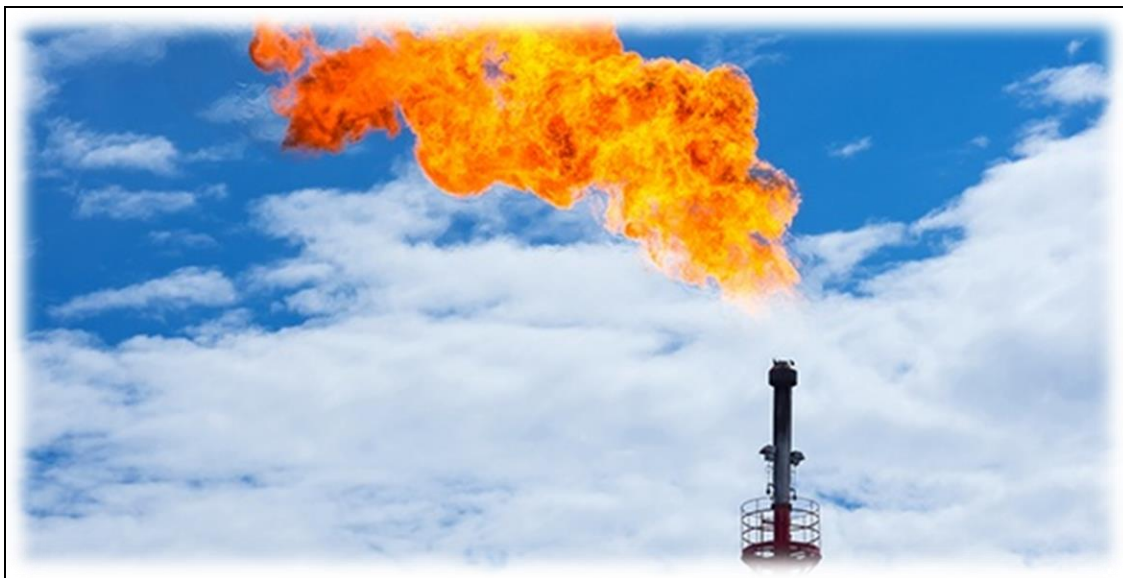
Figure II.1. Torche des gaz associés au pétrole brut [11]
