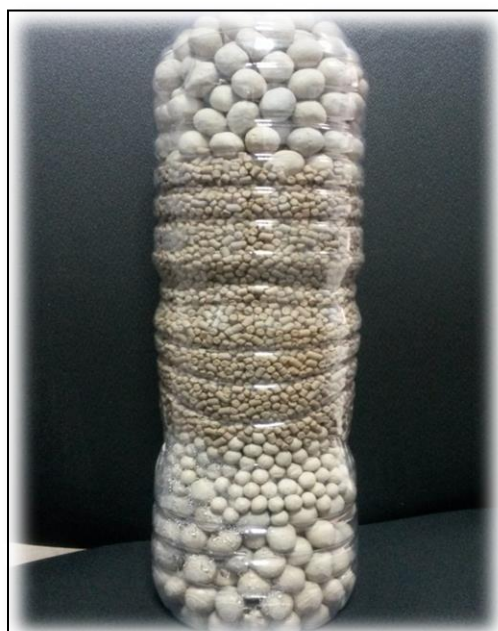
Figure IV.12. Position des billes adsorbants et le tamis moléculaire
