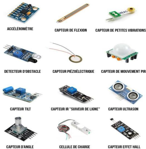
**Figure 1.8:** quelques capteurs [6].
