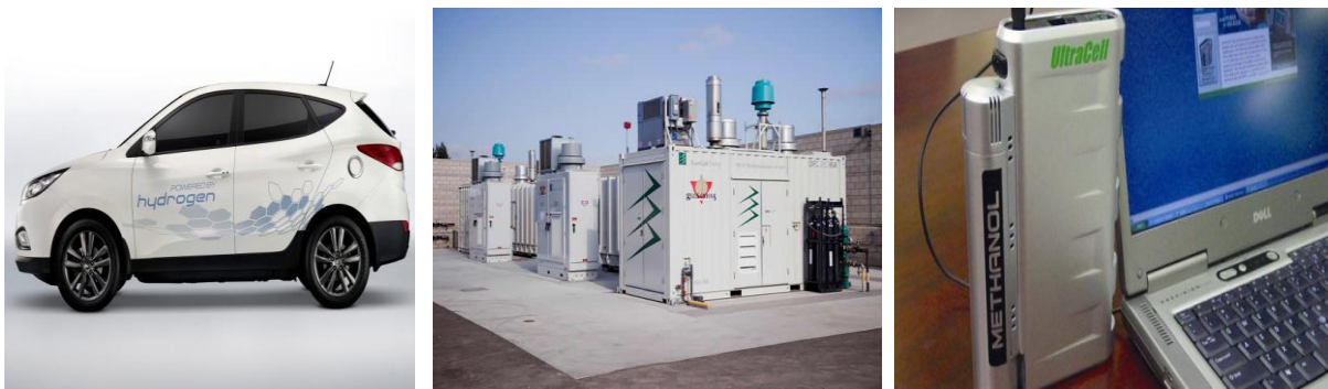
Figure I.9: Quelques applications de pile à combustible, (a) La Hyundai ix35 FECV est le premier véhicule à pile à combustible produit en série, (b) Unité de Pile à combustible, (c) Pile à combustible au méthanol Ultracell.
