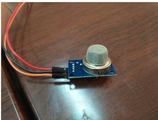
FIGURE 4.4: Capteur MQ2
