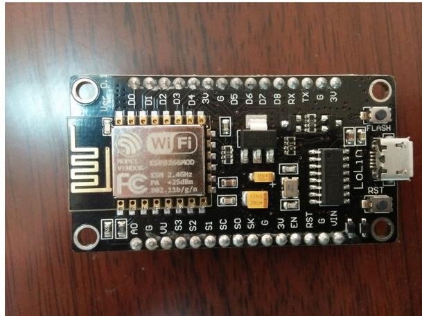
FIGURE 4.2: Le modèle Nodemcu ESP12
