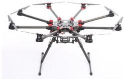
FIGURE 1.19: Illustration d'un Octocopters
