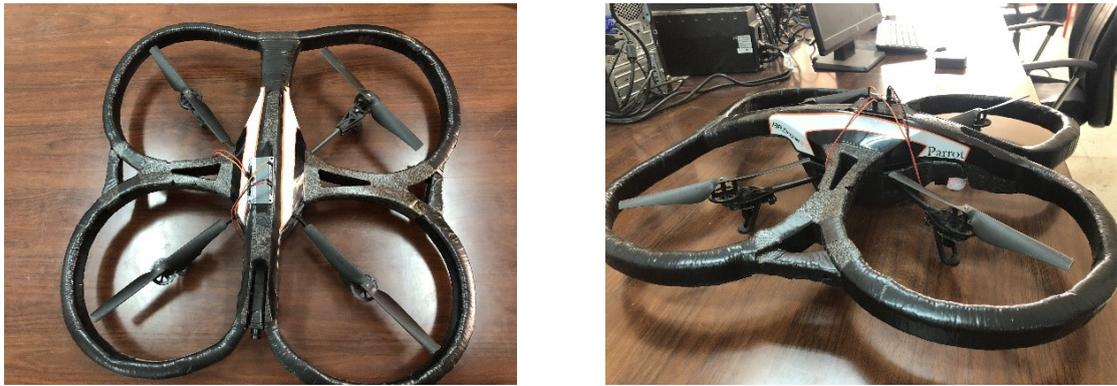
FIGURE 4.44: le drone avec le système de détection.
