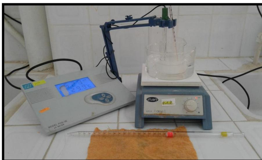
*Figure II.7 : Montage de l'extraction liquide-liquide.*
