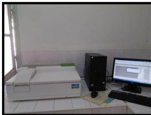
*Figure II.4 : Spectroscopie électronique UV- visible PerkinElmer(UV/VIS spectrometer Lambda25).*
