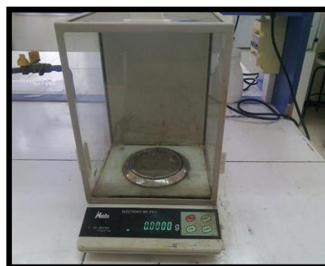
*Figure II.6 : Une balance électronique.*
