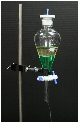
*Figure I.2 : Ampoule à décanter contenant de l'huile et de l'eau colorée.*
