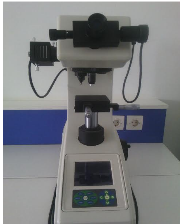
Figure III.2 Micro-duremètre Vickers de type HVS -1000 Z.
