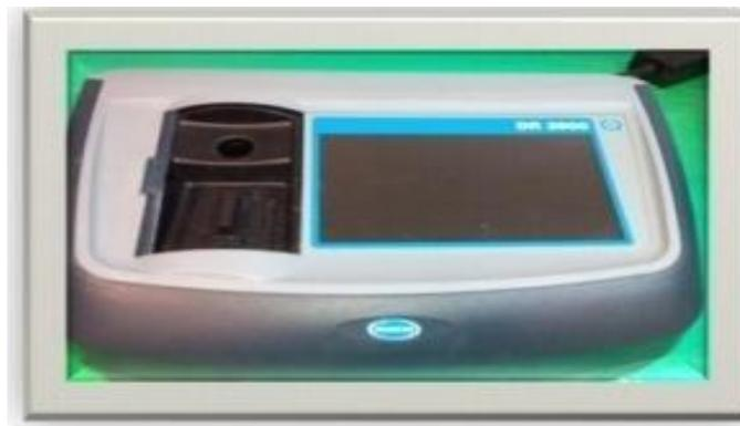
Figure IV.21. Spectrophotomètre DR 3900.
