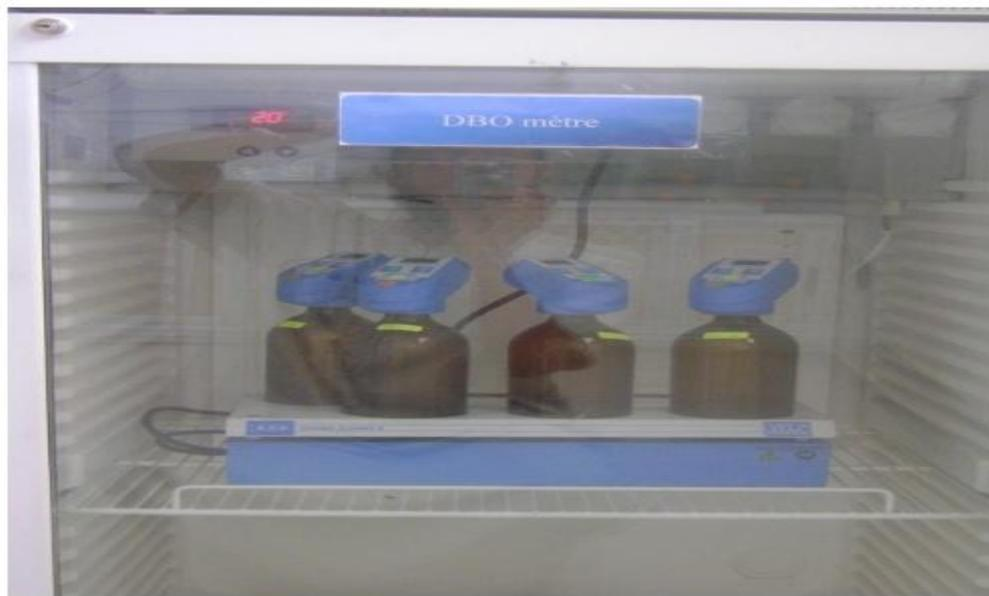
Figure IV.16. DBO mètre.
