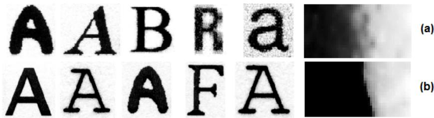
FIGURE 2.2: Exemple de différentes impressions : jet d'encre (a) et impressions laser (b).
