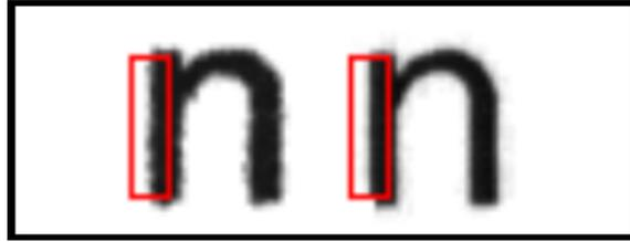
FIGURE 2.1: Comparaison de la rugosité des bords entre un jet d'encre (à gauche) et une imprimante laser (à droite).
