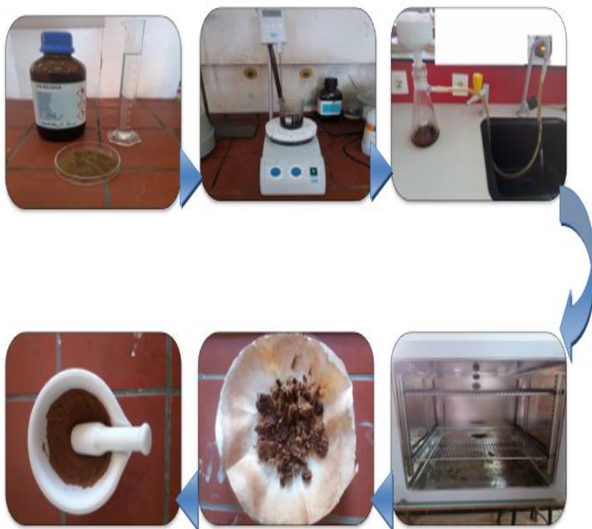
Figure III-13: Protocole traitement avec l'acide acétique (acétylation).
