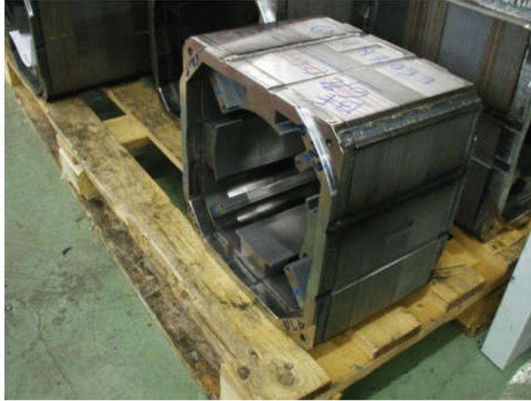
**Figure I.5.** Culasse, circuit magnétique statorique d'une machine à courant continu.
