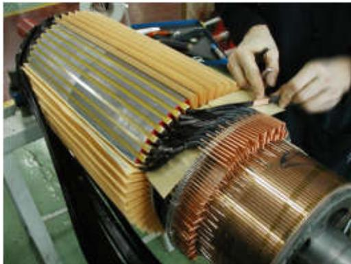
**Figure I.7.** Mise en place des conducteurs d'induit dans les encoches et soudure de ceux-ci sur le collecteur.
