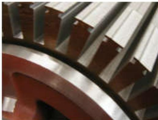
**Figure I.6.** Encoche sur l'induit destinée à recevoir les conducteurs dits actifs.
