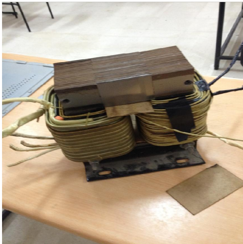
Fig.III.14. Resserrage des tôles
