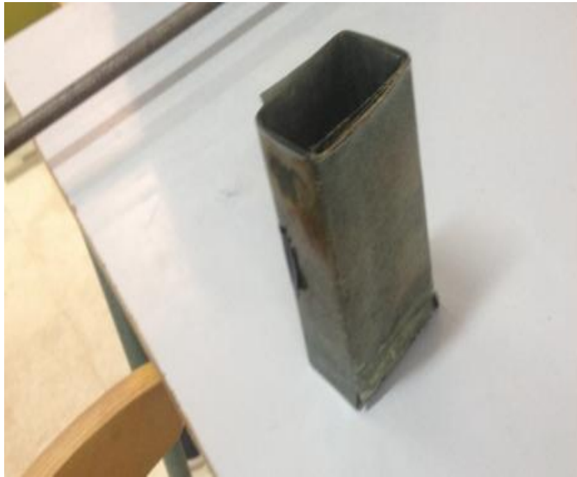
Fig.III.11. Support isolant entre enroulement et circuit magnétique
