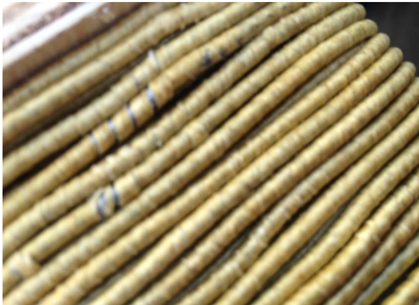
Fig.III.10. Enroulement à 280 spires récupérées de l'enroulement endommagé
