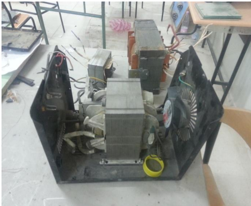
Fig.III. 1. Différents postes à soudeuse récupérés de la casse.
