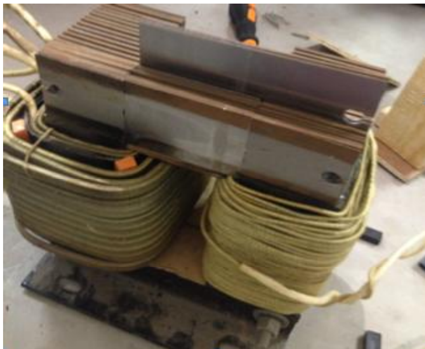
Fig.III.13. Remontage des tôles
