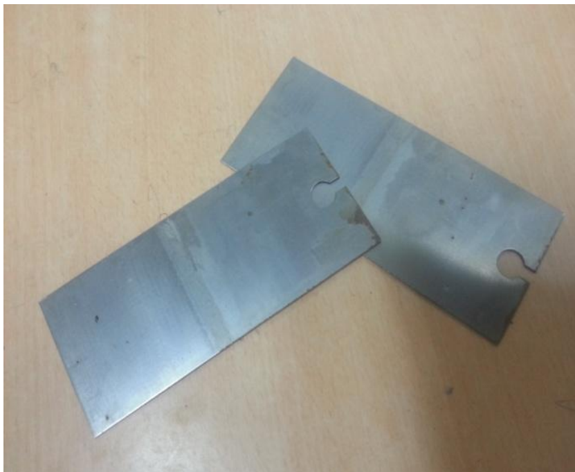
Fig.III.5. Tôles magnétiques utilisées dans la fabrication du circuit magnétique
