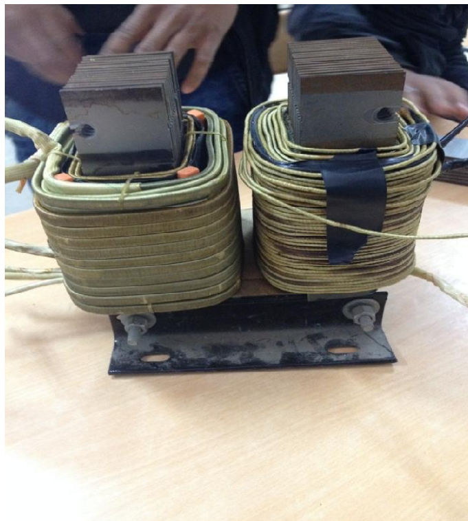
Fig.III.12. Bobinage primaire et secondaire placé sur le circuit magnétique
