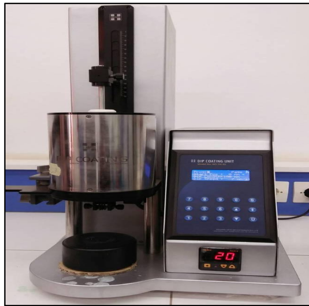
Figure II.10 Photo du montage expérimental du dip-coting
