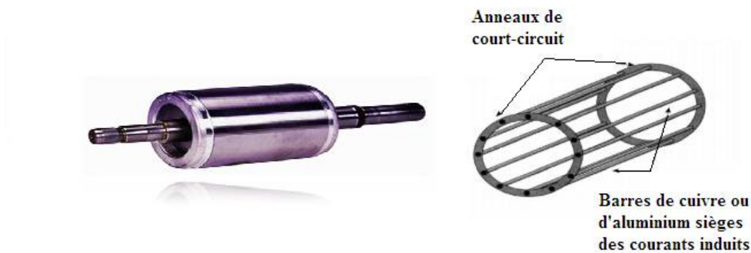
Fig.I.4 Rotor à cage d'écureuil [3][2].
