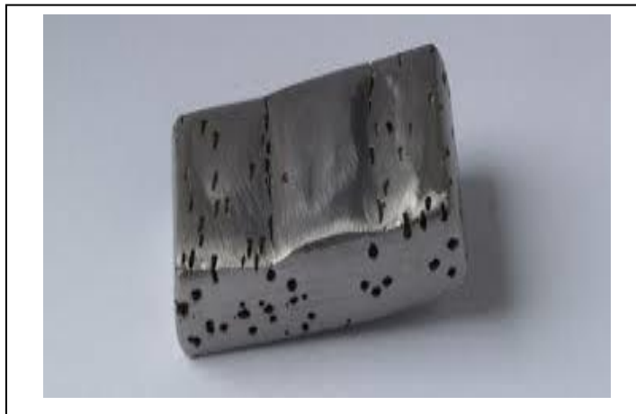
Fig.I.4. Corrosion par piqure.
