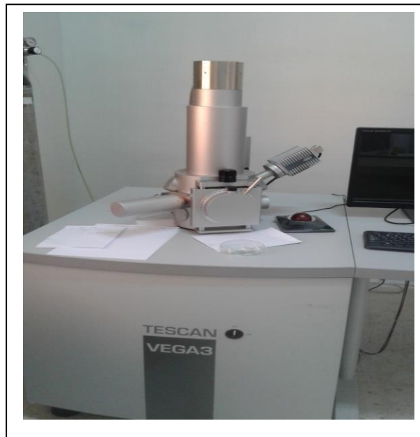
Fig II. 11. Microscopie électronique à balayage (MEB) de type TESCAN VEGA 3.
