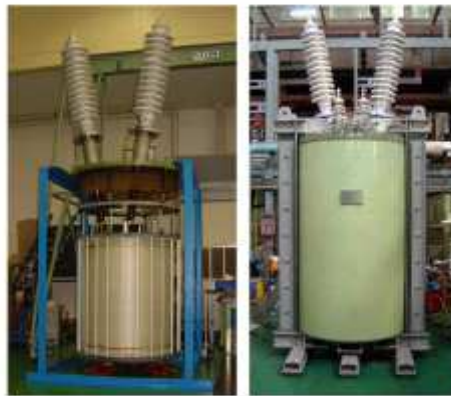
Figure. I.13 : Le transformateur 2 MVA HTS avant (à gauche) et après (à droite) l'assemblage.
