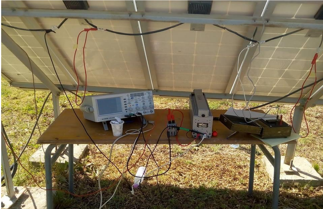
Figure IV- 2 : Montage pour relever la caractéristique I/V on utilisant l’oscilloscope GDS-2204
