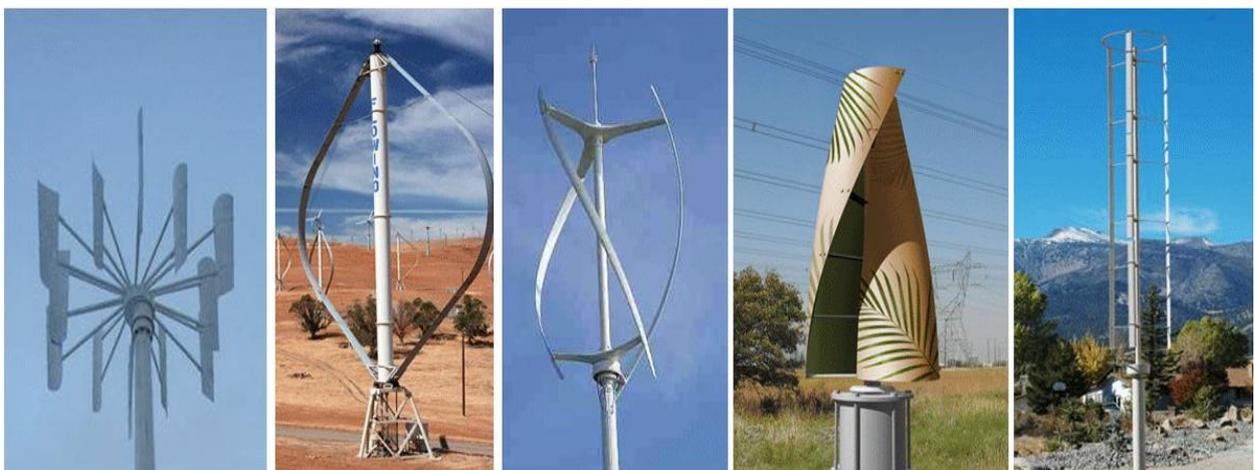
Figure (I.6) : Petites éoliennes à axe vertical
