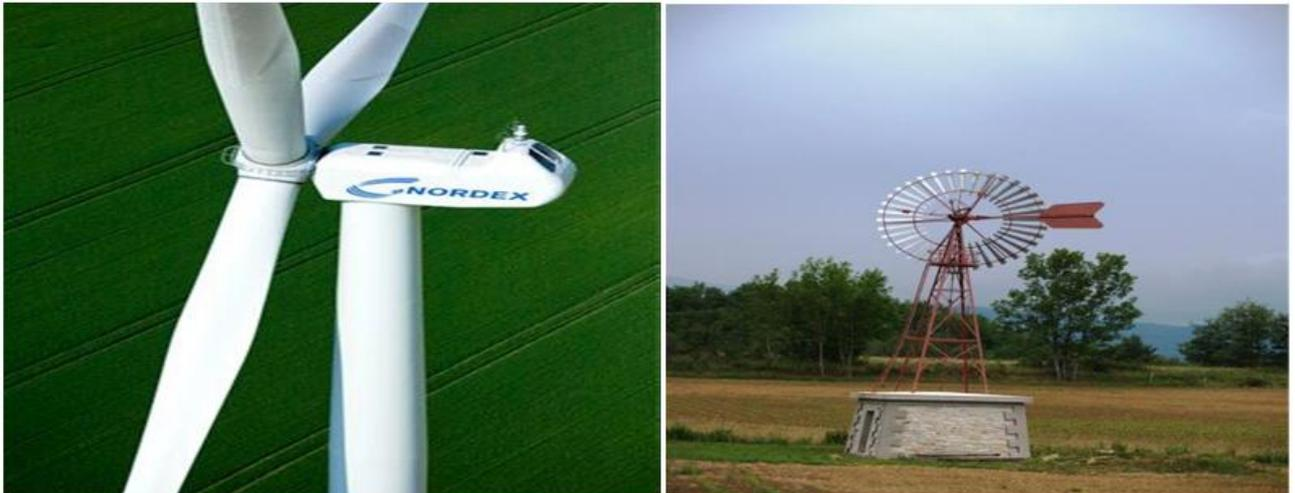
**Figure (I.9) :** Eoliennes tripales et multi-pales [19].
