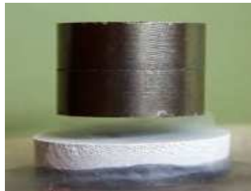
Figure I.20 – Un aimant flotte au dessus d'un supraconducteur
