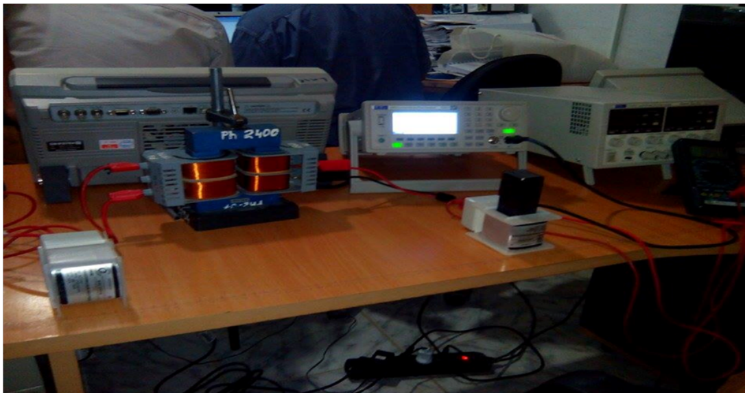
Fig 4.12: Bobine réceptrice avec barreau en ferrite renversée en position verticale
