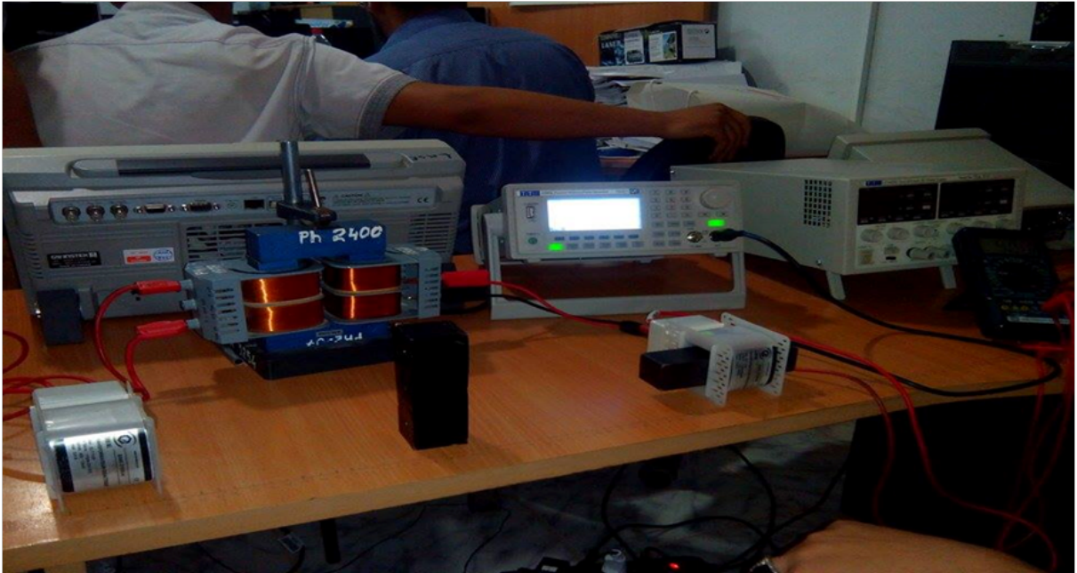
Fig 4.9: Barreau en ferrite dans la bobine émettrice avec corps ferromagnétique au centre PC
