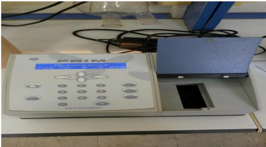
**Figure II.6 :** Spectrophotomètre visible PRIM SECOMAM RS-232.
