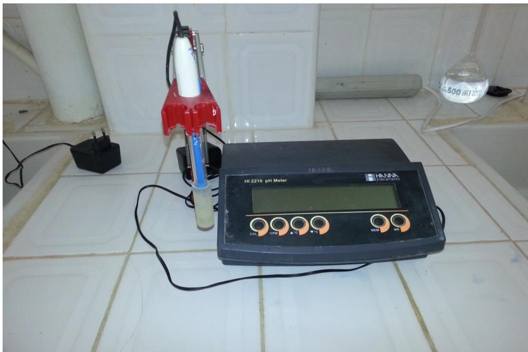
Figure II.5 : pH-mètre de type HI 2210.
