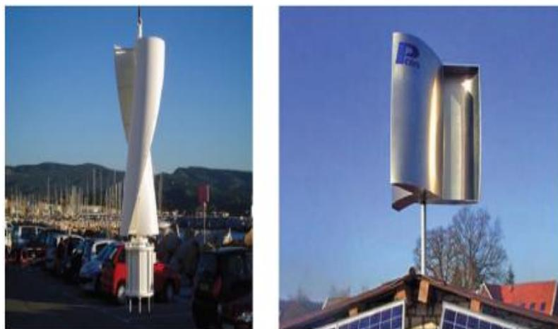
**Fig. 1.9 : éoliennes à axe vertical de type SAVONIUS [5].**
