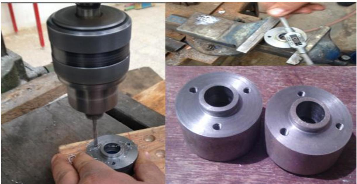
Fig. 3.6: Usinage des paliers
