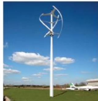
**Fig.1.10 : éoliennes à axe vertical de type DARRIEUS**
