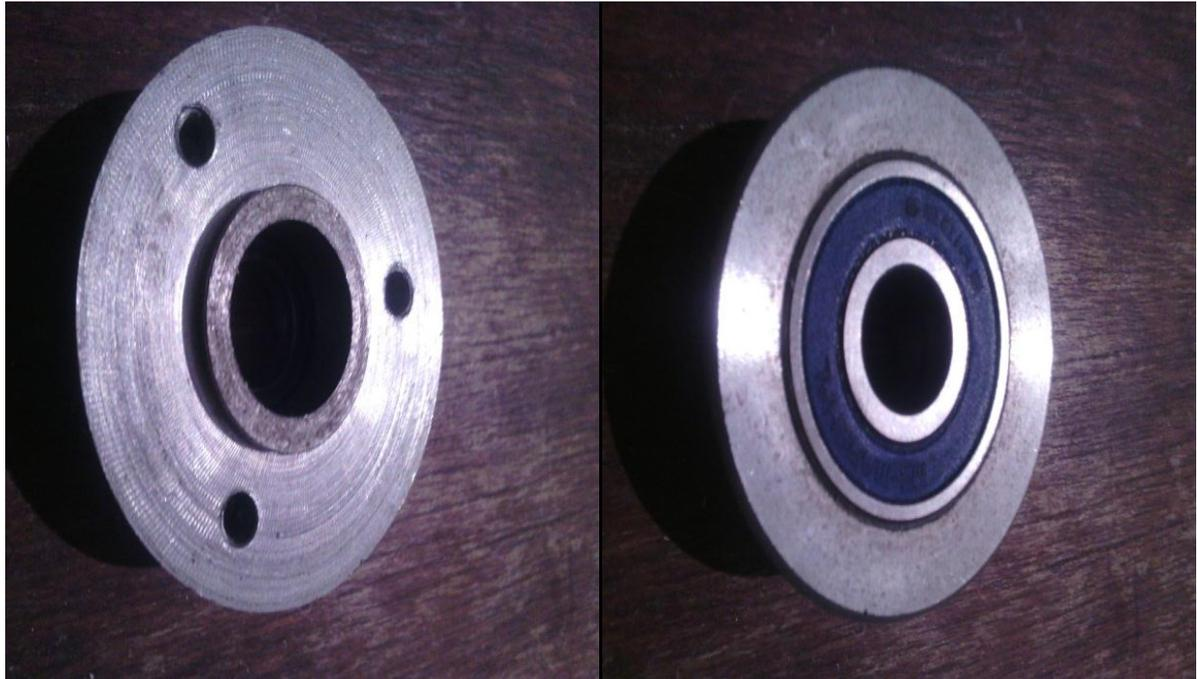
Fig. 3.5. Fixation du roulement sur palier (gauche vue de face, droite vue arrière)
