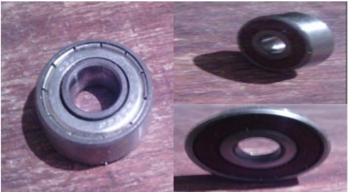
Fig. 3.3. Roulements de type BC utilisés
