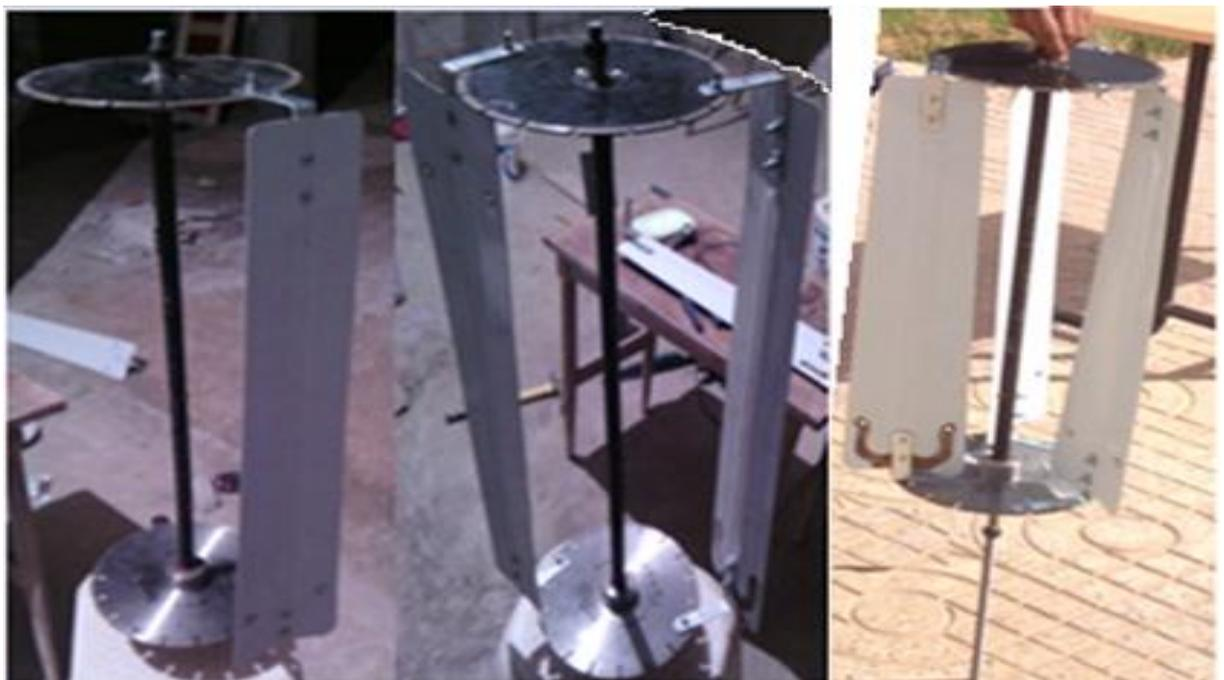
Fig.3.8. Fixation des pales sur les disques
