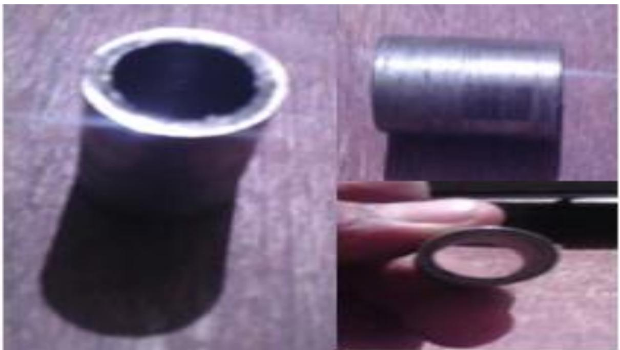
Fig. 3.4. Pièces cylindriques de séparation roulement-arbre
