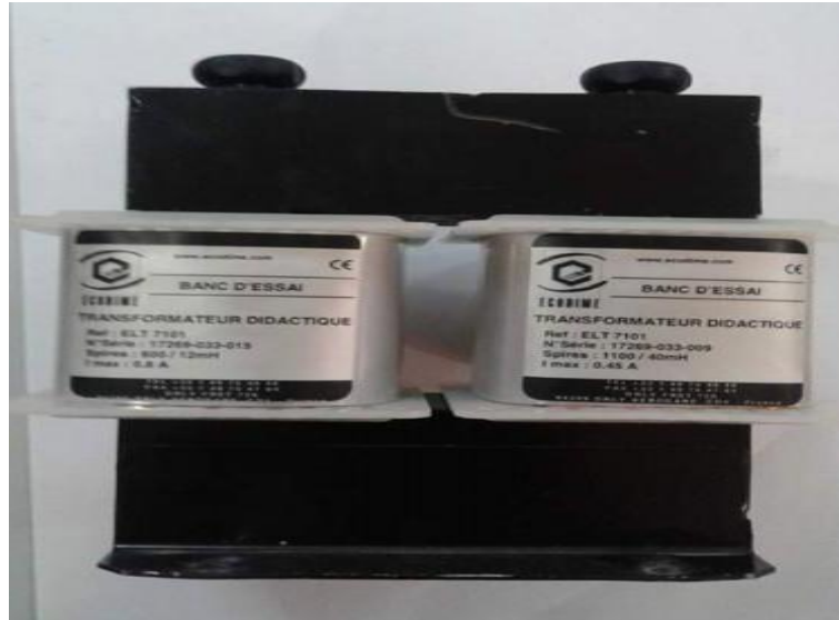
Fig.III.3 Le transformateur de la puissance T3
