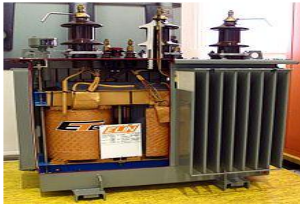
Fig. I.10 Transformateur de distribution avec vue de l'intérieur
