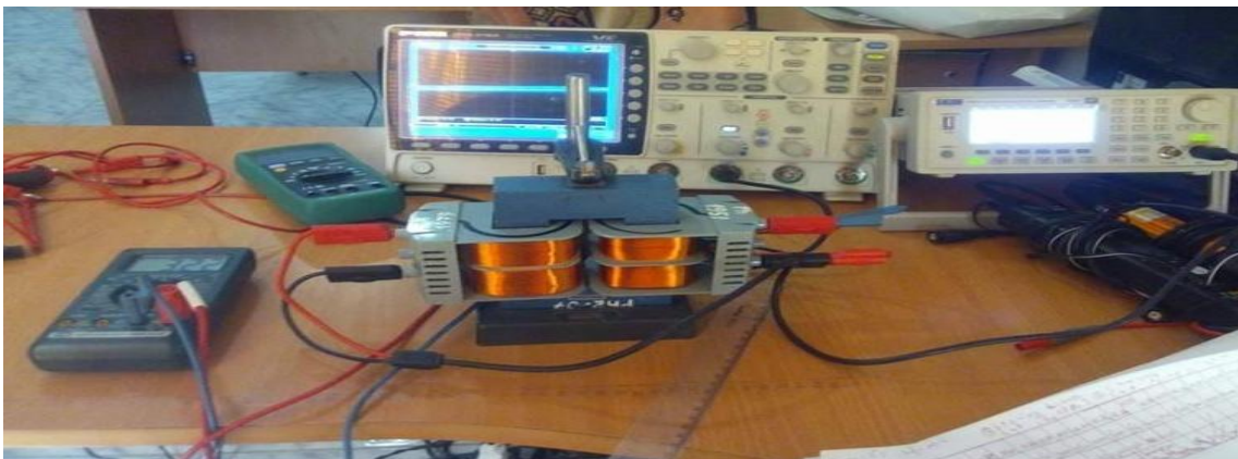
Le montage (2) de transformateur de la puissance T2
